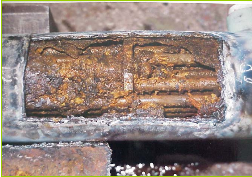
제 2 화성공장 Air Compressor After Cooler (1999. 2. 25 Test 시작) Cooler 내부의 Tube 가 거의 보이지 않을 정도의 많은 Scale 과 이물질이 보인다.
