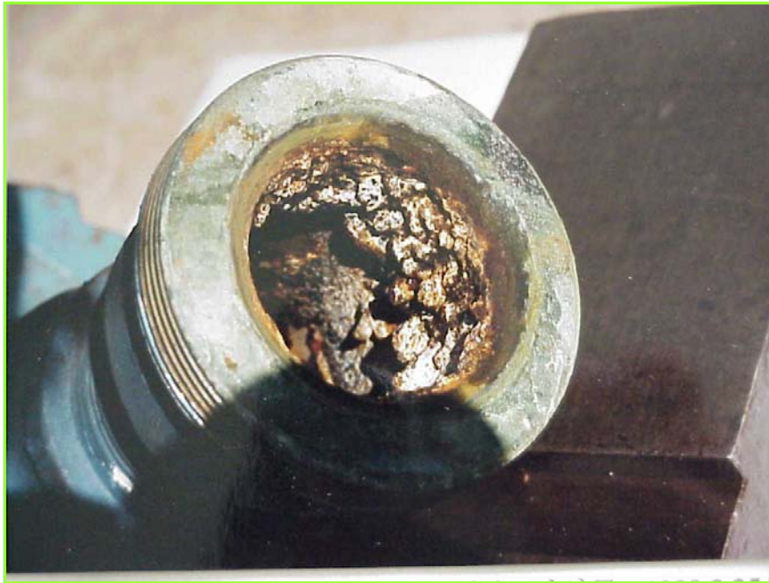
제 1 선재공장 Air Compressor Dryer 냉각수 인입구 (1999.2.25.Test 시작) 배관 내부에 Scale 이 장기간에 걸쳐서 생성되어 딱딱하게 굳어있는 상태이다.-- 제거에는 상당한 시간이 소요될 것으로 예상됨.
